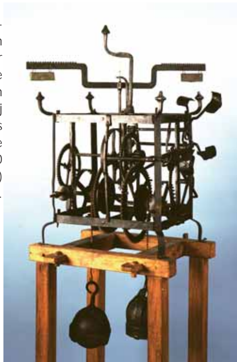
Smeedijzeren torenuurwerk met foliot, ca. 1520
